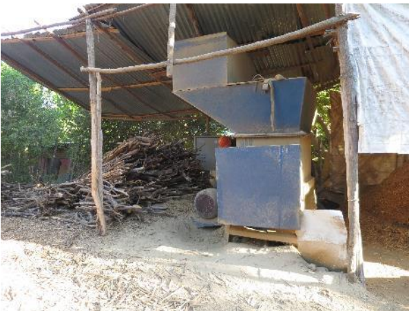
Figura 23. Planta procesadora en El Naranjo, Prov. Independencia. Aquí se acopia la madera de guaconejo y se muele, primero en astillas y luego en polvo parecido a aserrín. En la foto inferior derecha, están los sacos con el aserrín de guaconejo empacado y listo para ser enviado a las destiladoras.
